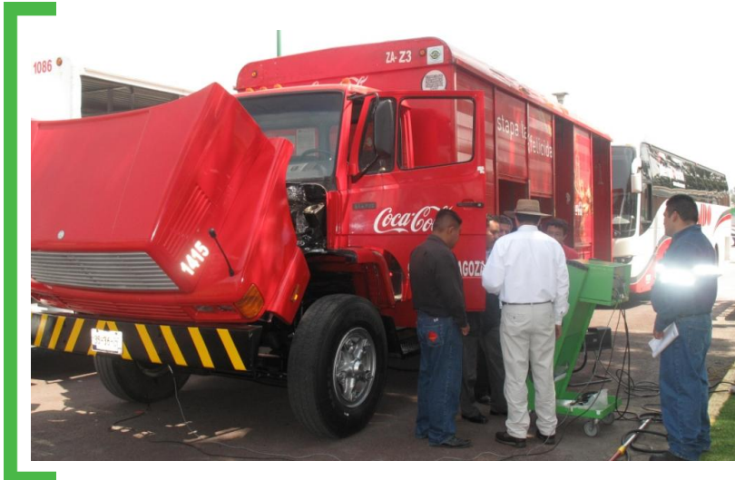
Imagen 5.4: Evaluación de opacidad de un automotor autorregulado
